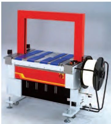
TP 601B: automatischer Band-einzug ohne Einfädeln
